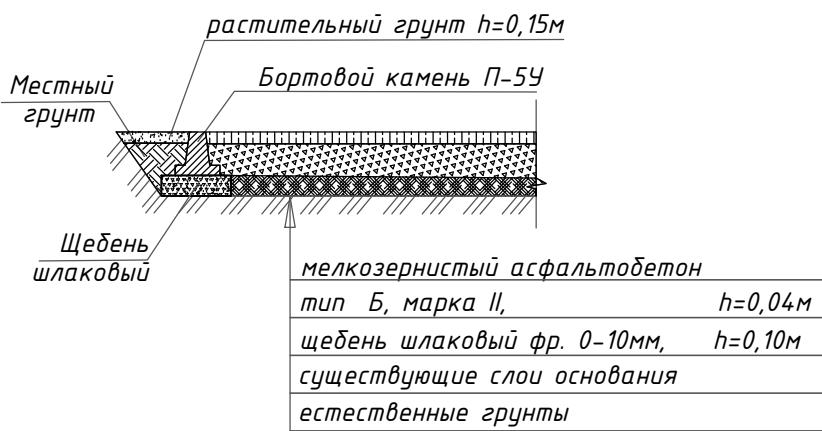
КОНСТРУКЦИЯ ПОКРЫТИЯ ТРОТУАРОВ
